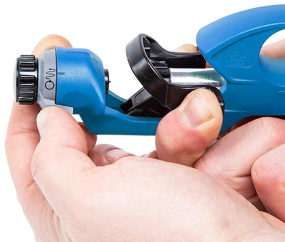
Pelador de Cable No. Espiral 4-29 es muy robusta, precisa y adecuada para los aislamientos blandos o duros de cables con un diámetro de 4,5 a 29 mm. Las diferentes direcciones de corte para el corte redondo, en espiral o longitudinal pueden ajustarse fácilmente a través de la posición de retención respectiva con la palanca de cambio. El corte en espiral facilita la eliminación de aislamientos complejos.
